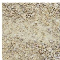
Sable ou grave calcaire compactés mécaniquement (sans liant): matériau économique, durable et semi-perméable pour l'aménagement de tous les chemins et parcours piétons
