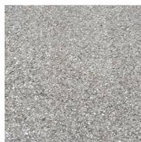
Enrobé à granulats calcaires pouvant être grenailé pour en éclaircir la teinte (qui s'éclaircira de toute façon naturellement dans le temps) : revêtement adapté aux voiries à plus forts trafics tel que les RD aux abords du carrefour antique
