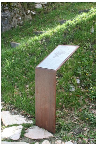
*Pupitre et totem en acier corten mis en œuvre au pied de l'accès à la Porte Majoue, avec plaque de dibon en aluminium brossé imprimé et découpes laser.*
